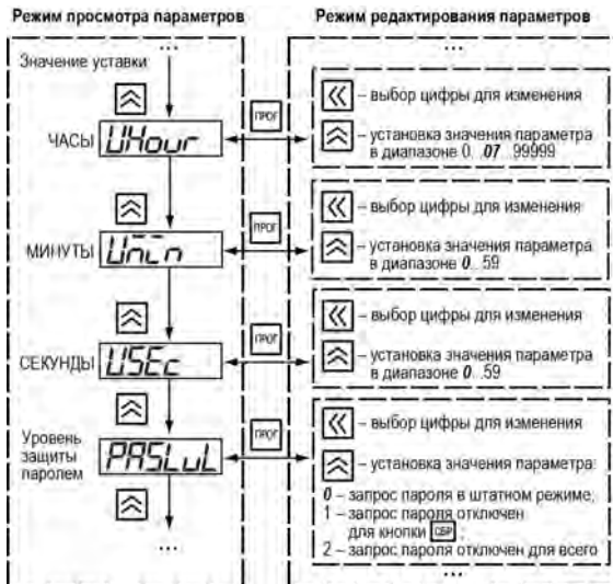
Рисунок 7.1 – Меню настроек прибора (начало)
